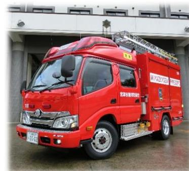
車体中央には 600 リットル水槽を装備し、消火装置は圧縮空気泡消火装置（CAFS）を採用したことで、水利の少ない山間部や高速道路等においても、少量の水で高い消火性能を発揮できます。
