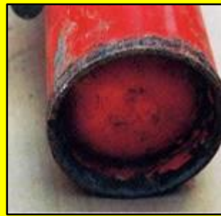
接部・その周辺の腐食
