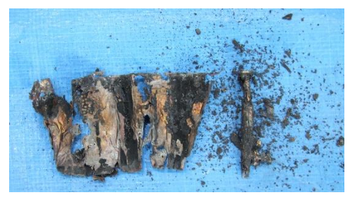
破裂したリチウムイオン電池
