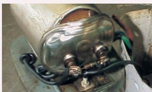
内部素子の絶縁破壊によりコンデンサケース内圧が増大し、ケースが破壊したものの。
