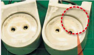
ソケットの汚損がひどく、クラックも入っています。更に内部の導電板も著しく酸化しています。
