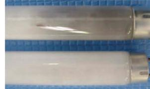
ランプのフィラメント付近が黒化し、放電性能が低下しています。
