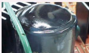
電子安定器の電解コンデンサ内の電解液が霧状になり放出し、コンデンサ上部が膨れ上がったもの。
