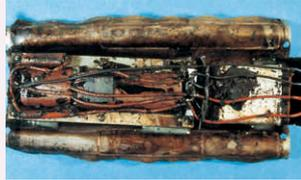
劣化の進んだ安定器の内部例:ビニル電線被覆が熱のために変形し、もろくなっています。
