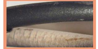
表面に亀裂が認められ絶縁性能が劣化しています。
