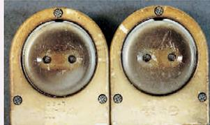
ソケットが熱劣化により変色しています。ひび割れから破損に至り、ランプが落下する危険があります。
